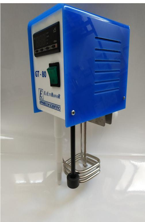
Il Gruppo Termostatico di precisione GT-80 viene utilizzato per applicazione in vasca. L'apparecchio è dotato di un termoregolatore digitale tipo P.I.D. con impostazione della temperatura da ambiente fino 80°C visualizzata su display a 3 cifre con una risoluzione di un decimo di grado.
